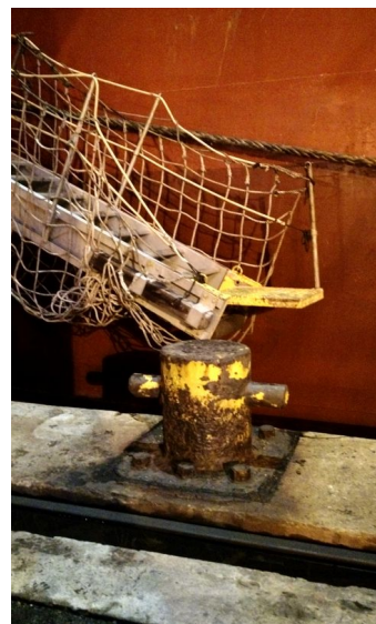
Figura 7: Escada sem contato com o solo e com obstáculo para acesso
